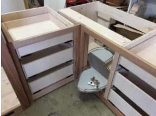
Montage du mécanisme d'angle
